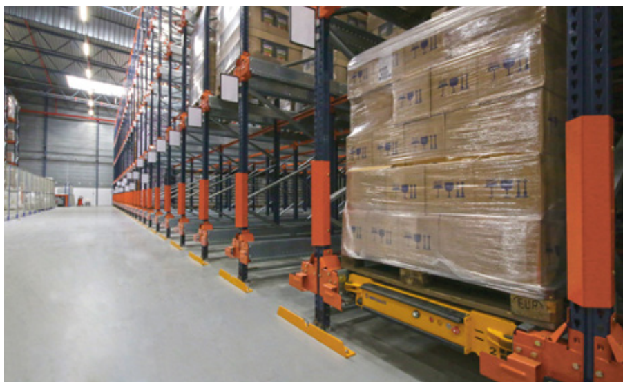
Przenośnik o długości 42 m transportuje towary z prędkością 10 m/min
