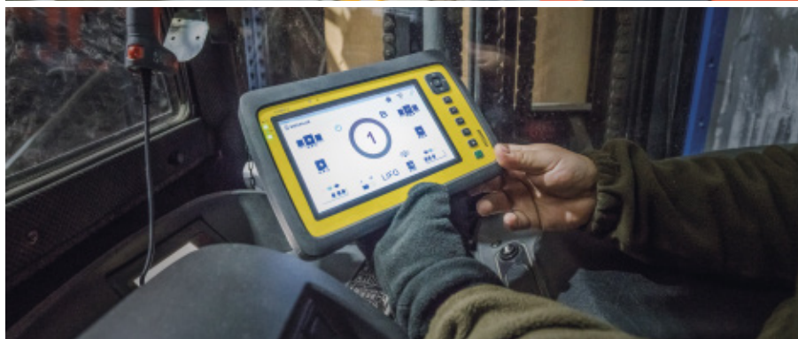
Operator wózka wysokiego składowania steruje wózkiem Pallet Shuttle za pośrednictwem tabletu przystosowanego do pracy w niskiej temperaturze z łączem Wi-Fi.
