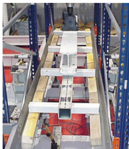
Rysunek 4. Testy szyn w instalacji regałów wjezdnych
