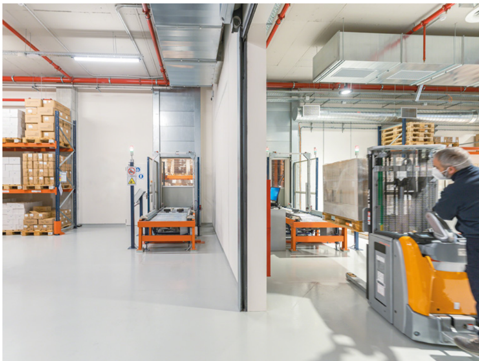
W magazynie automatycznym stanowiska przyjęć/wydań towaru są dwukierunkowe
