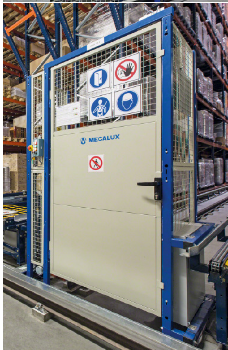
Ogrodzenie strefy kontroli i utrzymania ruchu
