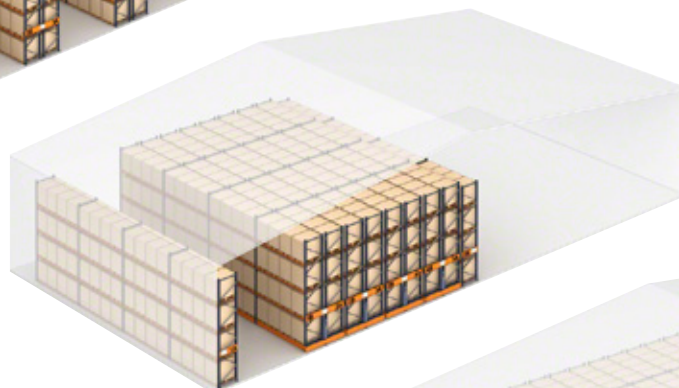
Magazyn z regałami przesuwными. Eliminacja większości korytarzy roboczych pomiędzy regałami zapewnia tę samą pojemność magazynu na mniejszej powierzchni.
