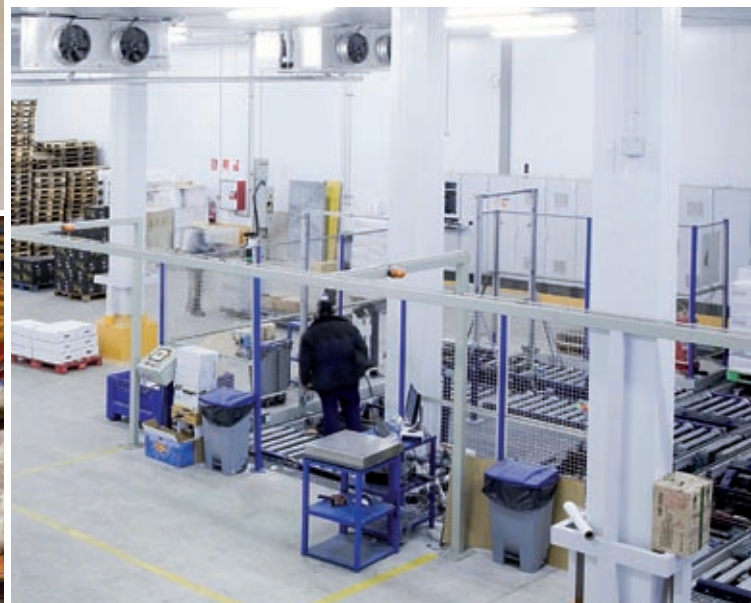
Kompletacja zamówień na przenośnikach w magazynie automatycznym
