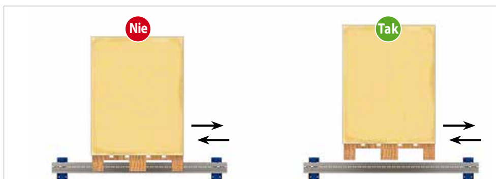
Rysunek 10. Nie ciągnąć palety po szynach
