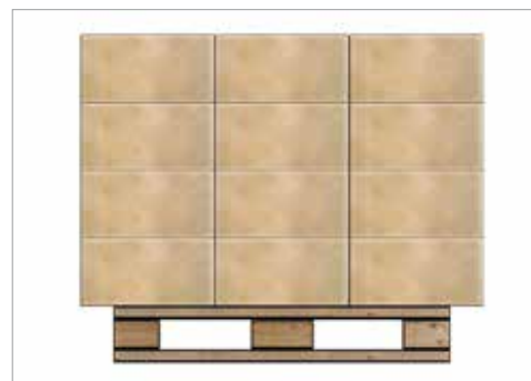
Większy ładunek wyśrodkowany na paletce
