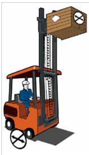
Rysunek 1. Zakaz jazdy z podniesionym ładunkiem
