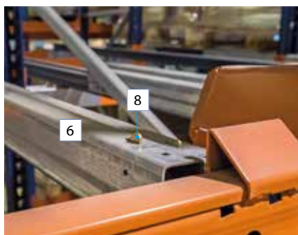
Wózek (6) i blokada zabezpieczająca (8).
