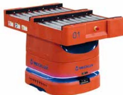
AMR 100 Box z podwójnym przenośnikiem w wersji poprzecznej do pobierania ładunków stroną o wymiarze 400mm.
