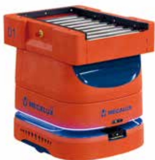
AMR 100 Box z przenośnikiem w wersji czołowej do pobierania ładunków stroną o wymiarze 400 mm.
