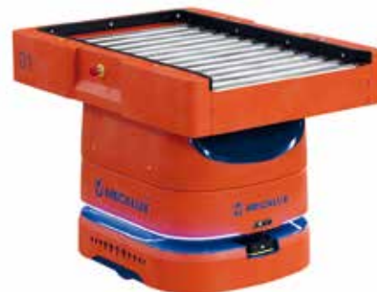
AMR 100 Box z przenośnikiem w wersji czołowej do pobierania dwóch ładunków szeregowo stroną o wymiarze 600 mm.
