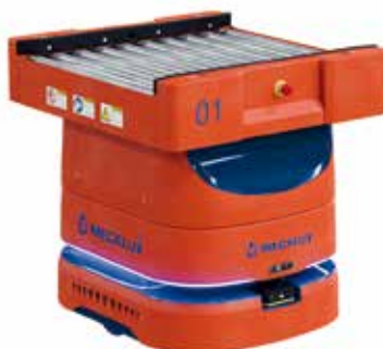
AMR 100 Box z przenośnikiem w wersji poprzecznej do pobierania ładunków stroną o wymiarze 600 mm.
