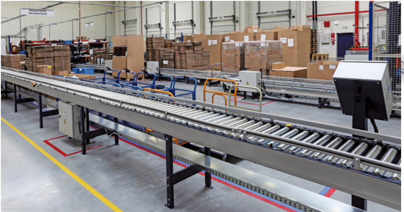
Pojemniki przemieszczają się na stanowisko kompletacji ręcznej po przenośnikach, których długość całkowita wynosi 38,2 m
