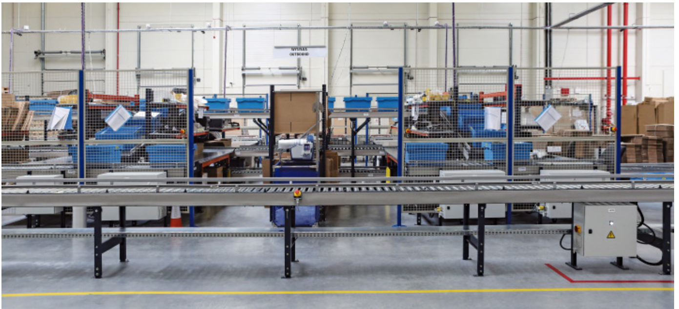
Pojemniki przemieszczają się na stanowisko kompletacji ręcznej po przenośnikach, których długość całkowita wynosi 38,2 m
