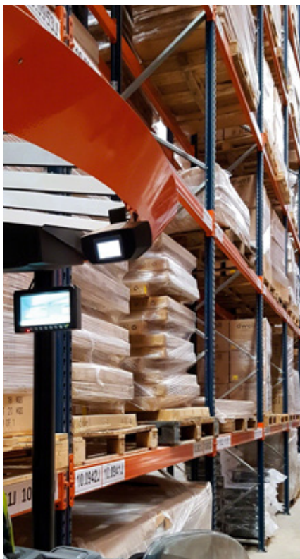
Monitor wyświetla obraz z kamery zainstalowanej na widłach wózka.
