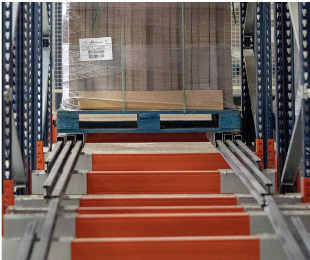
Wózki i szyny na regałach push-back służą do łatwego i płynnego przesuwania palet z towarem.
