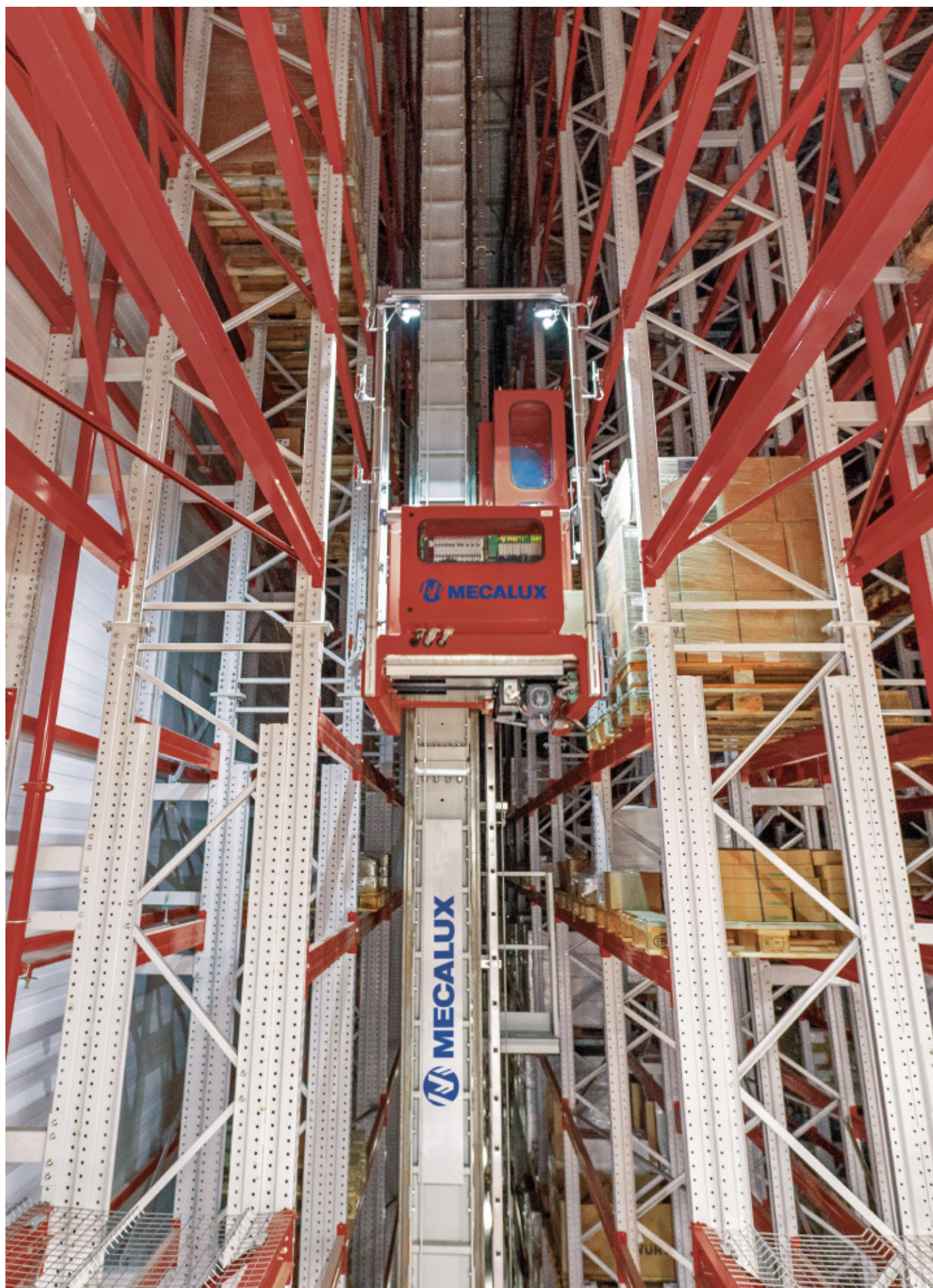
Jednokolumnowa układnica o pojedynczej głębokości i prędkości przemieszczania 220 m/min w poziomie i 54 m/min w pionie.
