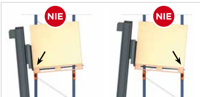
Rysunek 9. Przeciążenie belki nośnej wskutek niewłaściwego opuszczenia ładunku
